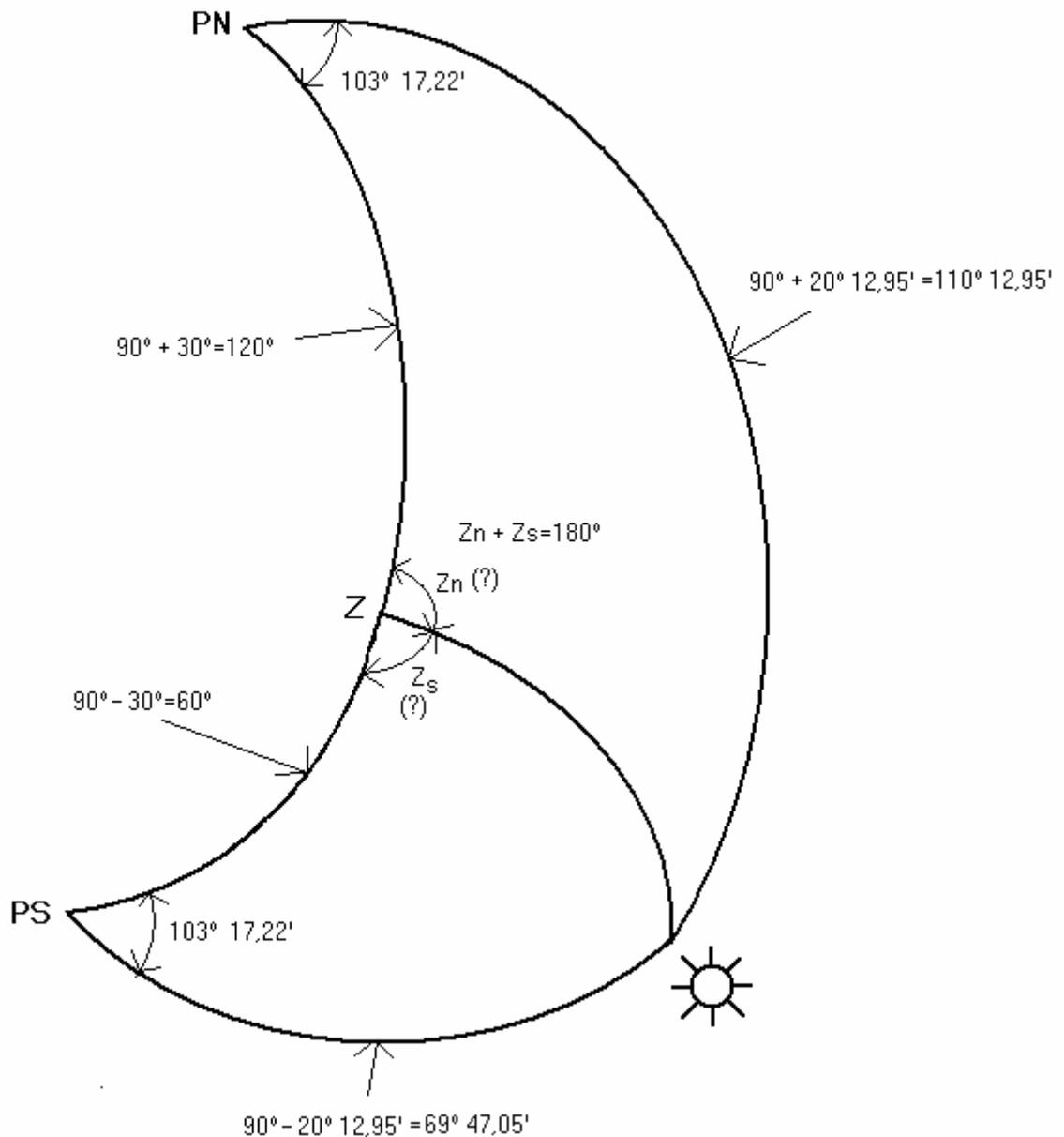
La figura anterior muestra de forma didáctica los dos triángulos de posición que se forman. Los lados desde el PS al PN son círculos máximos de la esfera, y por supuesto miden los dos  $180^\circ$ . El polo elevado es el PS ya que es el que corresponde con la latitud del observador.
