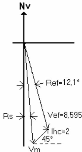
Si  $V_{mx}$  y  $V_{my}$  son las coordenadas x e y respectivamente de la velocidad de máquinas  $V_m$ ,
